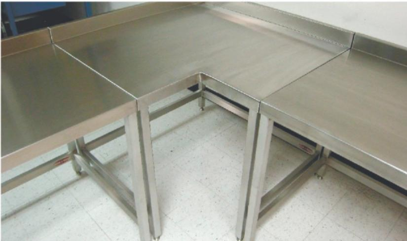
Нержавейка обрела огромную популярность в пищевом производстве из-за своего высокого уровня сопротивления коррозии, который она приобретала благодаря высокому содержанию хрома в металле.
